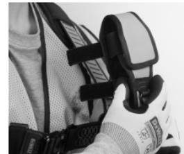
Dérouler les deux bandes à boucles et à crochets fournies sur la bande de la pochette mobile. Attacher la bande de sac mobile à la sangle du harnais à l'endroit de votre choix.
