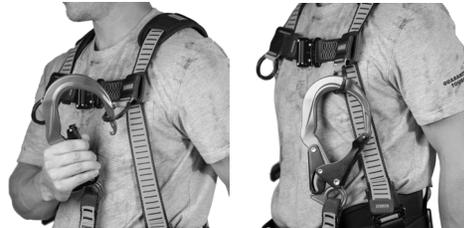
**Attache-sangle:** Les harnais DeWALT sont fournis avec des attache-sangle qui servent à contrôler les extrémités lâches des sangles. Ces extrémités lâches des sangles, si elles ne sont pas contrôlées, peuvent se coincer dans la machinerie ou causer un désengagement accidentel d'un dispositif d'ajustement. Par conséquent, l'utilisateur doit s'assurer qu'il n'y a pas d'extrémités lâches de sangles et qu'elles sont maintenues en place par les attaches.
