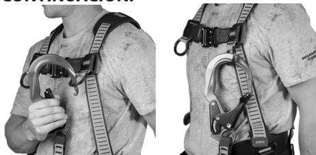
**Seguros de tejido trenzado:** Los arneses DeWALT se proporcionan con seguros de tejido trenzado que sirven para controlar los extremos sueltos de las correas. Estos extremos sueltos de las correas, si no se controlan, pueden quedar atrapados en la maquinaria o causar la desconexión accidental de un ajustador. Por lo tanto, el usuario debe asegurarse de que no haya extremos sueltos de las correas y de que estos se mantengan en su lugar mediante los seguros de tejido trenzado.
