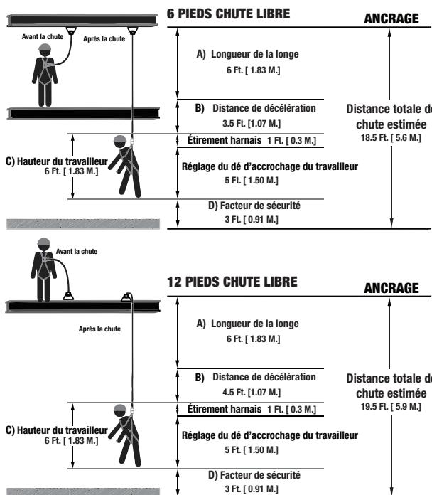
**AVERTISSEMENT:** Le dispositif antichute DOIT SEULEMENT être connecté à l'élément de fixation arrière du harnais fourni à l'usage (dé d'accrochage ou rallonge de fixation de sangle) ou aux points d'ancrage à hauteur de thorax (« maillon de sangle » ou maillon d'accrochage). Les dés d'accrochage de la ceinture et le point d'ancrage à hauteur du ventre ne doivent être utilisés que pour la fixation d'un système de maintien ou de retenue de travail et jamais avec un dispositif antichute.
