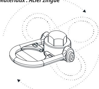
Ancre à bascule à point unique pour structure en béton (DXFP843101)
