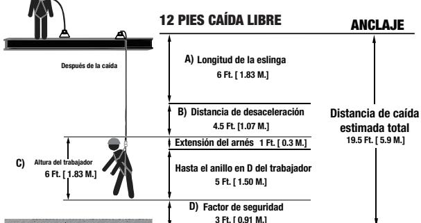
**ADVERTENCIA:** El sistema de detención de caídas SOLO DEBE conectarse al elemento de fijación posterior del arnés proporcionado para el propósito (anillo en "D" o extensión de fijación de tejido trenzado) o a los puntos de anclaje del pecho ("eslabón de tejido trenzado" o eslabón en "D"). Los anillos en D del cinturón y el punto de anclaje ventral solo deben utilizarse para la fijación de un sistema de posicionamiento o retención de trabajo y nunca con un sistema de detención de caídas.
