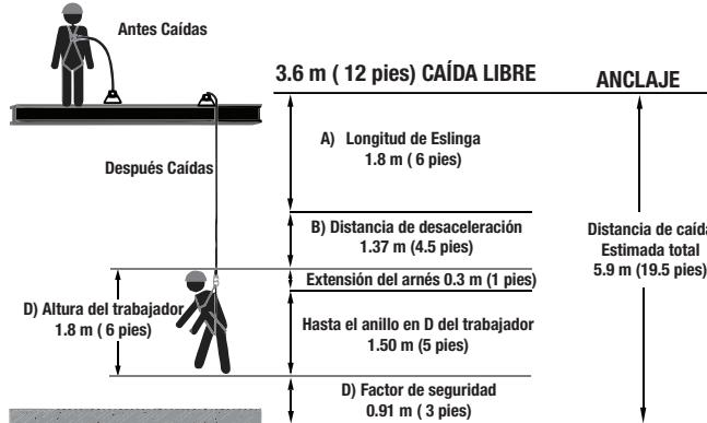
**ADVERTENCIA:** El sistema de detención de caídas SOLO DEBE conectarse al elemento de fijación posterior del arnés proporcionado para el propósito (anillo en "D" o extensión de fijación de tejido trenzado) o a los puntos de anclaje del pecho ("eslabón de tejido trenzado" o eslabón en "D"). Los anillos en D del cinturón y el punto de anclaje ventral solo deben utilizarse para la fijación de un sistema de posicionamiento o retención de trabajo y nunca con un sistema de detención de caídas.
