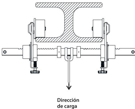
*El transportador de anclajes de viga está diseñado para instalarse en bridas de viga de 8 cm (3,15 in) a 25 cm (9,84 in) de ancho.*
