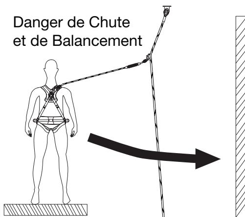
**! AVERTISSEMENT:** NE JAMAIS fixer le dispositif sur la ligne de vie avec la flèche pointant vers le bas ; si une chute se produit, il ne se verrouillera pas sur la ligne de vie.
