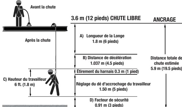
**AVERTISSEMENT:** Le dispositif antichute DOIT SEULEMENT être connecté à l'élément de fixation arrière du harnais fourni à l'usage (dé d'accrochage ou rallonge de fixation de sangle) ou aux points d'ancre à hauteur de thorax (« maillon de sangle » ou maillon d'accrochage). Les dés d'accrochage de la ceinture et le point d'ancre à hauteur du ventre ne doivent être utilisés que pour la fixation d'un système de maintien ou de retenue de travail et jamais avec un dispositif antichute
