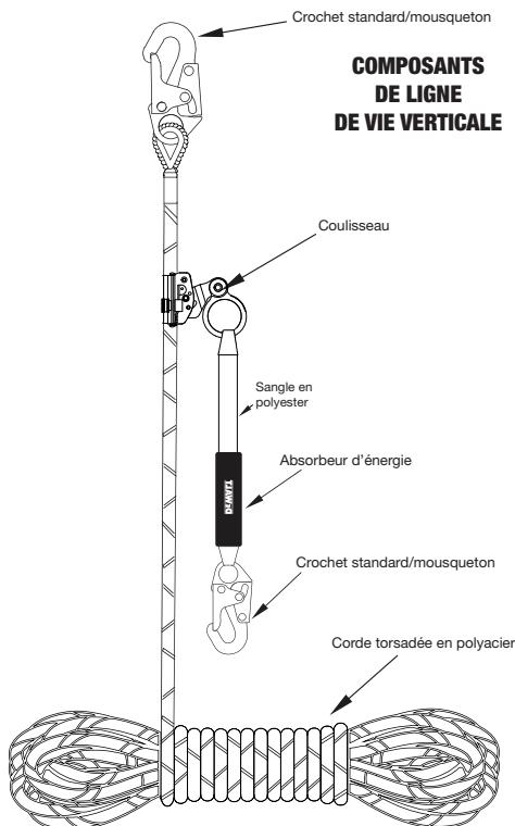
**AVERTISSEMENT:** Tout équipement soumis à une chute ne doit plus être utilisé.
