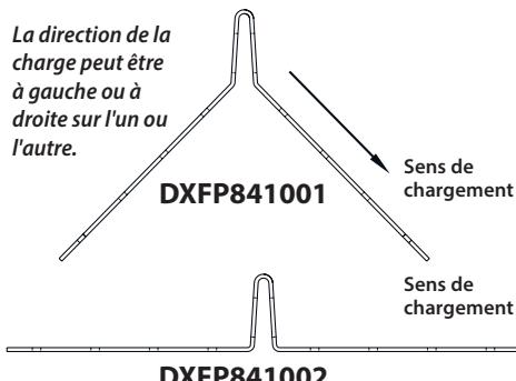
L'ancre peut être fixé de manière à ce que les impacts de charge soient dans le sens indiqué dans la figure ci-contre :-
