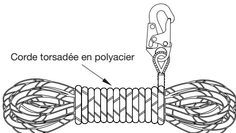
L'ensemble de ligne de vie verticale DEWALT est livré avec une corde torsadée en Polysteel de 15,24 m (50 pi) de long et 1,58 cm (5/8 po) d'épaisseur, un crochet standard fixé en permanence et un coulisseau avec absorbeur d'énergie fixé.
