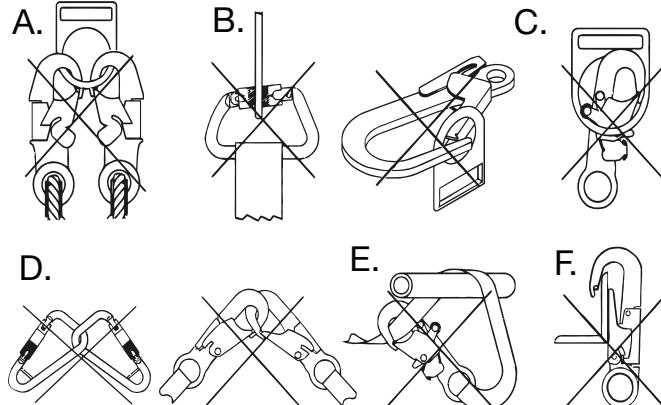
**Avertissement:** Si l'élément de connexion auquel un crochet standard (illustré) ou un mousqueton est fixé est de forme sous-dimensionnée ou irrégulière, une situation pourrait se produire où l'élément de connexion applique une force à la clavette du crochet standard ou du mousqueton. Cette force peut entraîner l'ouverture de la clavette (d'un crochet standard auto-verrouillant ou non), permettant au crochet standard ou au mousqueton de se désengager du point de connexion.
